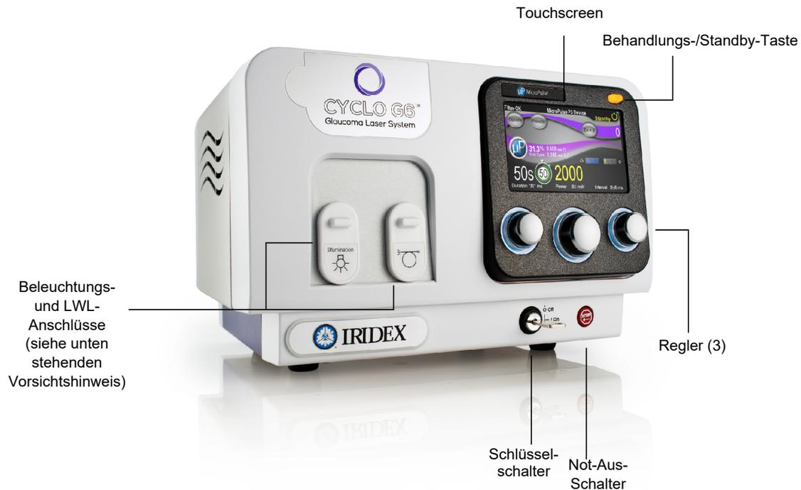
**ACHTUNG:** Ist kein Behandlungsgerät am Laser angeschlossen, ist darauf zu achten, dass die Beleuchtungs- und LWL-Anschlüsse geschlossen sind.
