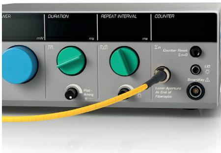
Spoj kabela optičkog vlakna za obitelj laserskih konzola OcuLight
