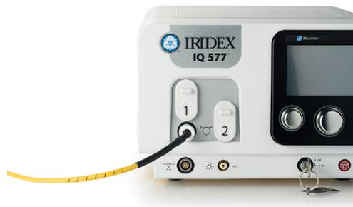
Spoj kabela optičkog vlakna za obitelj laserskih konzola IQ. Priključite na priključak 1 ili priključak 2
