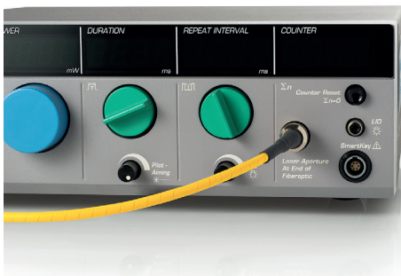
Valokuitukaapelin liitäntä OcuLight-tuotteen laserkonsoliin
