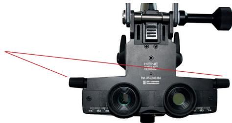
8. À l'aide du condenseur et du bouton de réglage du faisceau de visée vertical situé en dessous du capot antipoussière, mettre au point le faisceau de visée et le positionner au centre du champ d'éclairage déjà projeté sur le front du patient.
