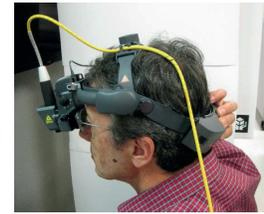
4. Régler l'emplacement des fentes de l'unité de visualisation du LIO de haut en bas et d'avant en arrière à l'aide de la vis à main et les fixer en place.
