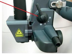
2. Sélectionner le réglage de filtre désiré à l'aide du levier de commande de filtre. Les réglages disponibles comprennent : aucun filtre, un filtre interférentiel anérythre, un filtre bleu ou jaune pouvant être introduit dans le faisceau d'éclairage.
