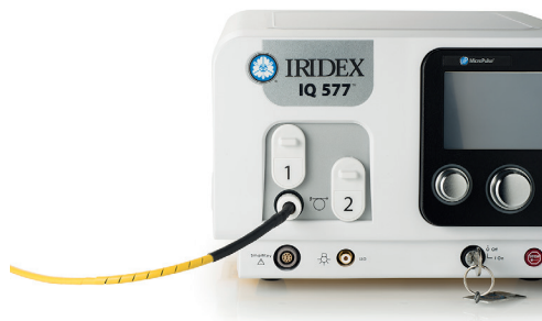
Σύνδεση καλωδίου οπτικής ίνας στη σειρά κονσολών λέιζερ IQ. Σύνδεση στη θύρα 1 ή στη θύρα 2
