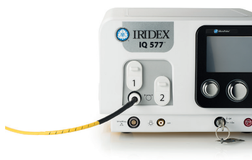
Fiberoptisk kabeltilkobling til serien av IQ-laserkonsoller. Koble til enten port 1 eller port 2
