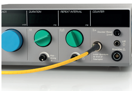
Fiberoptisk kabeltilkobling til serien av OcuLight-laserkonsoller
