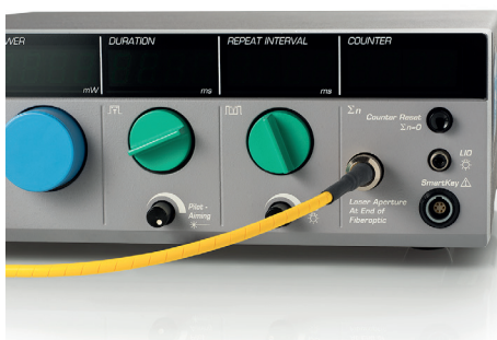
Połączenie kabla światłowodowego z konsolami lasera z grupy OcuLight
