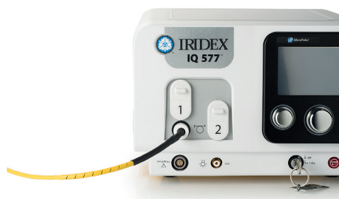
Połączenie kabla światłowodowego z konsolami lasera z grupy IQ. Podłączyć do portu 1 lub 2
