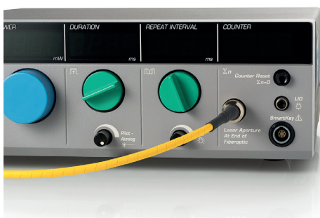
Pripojenie optického kábla k laserovým konzolám radu OcuLight
