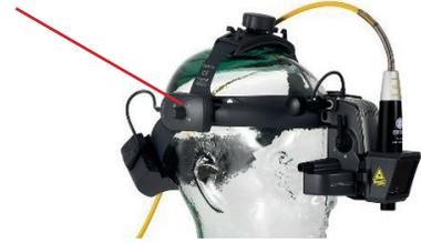
7. Conecte el cable de fibra de LIO a una consola de láser compatible con la longitud de onda correcta para el tratamiento. Encienda el haz de referencia y ajuste la intensidad en el panel de control del láser.
