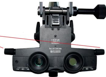
8. Utilizando la lente condensadora y el control del haz de referencia vertical situado debajo de la unidad de cubierta, enfoque y posicione el haz de referencia en el centro del campo de iluminación ya proyectado sobre la frente del paciente.
