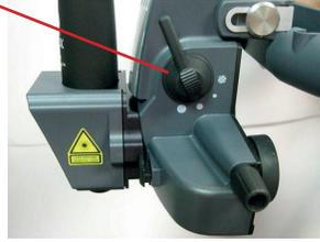
2. Seleccione el ajuste de filtro deseado utilizando la palanca de control de filtro. Los ajustes disponibles son: sin filtro, filtro de interferencia sin rojo y filtro azul o amarillo que se pueden incorporar al haz de iluminación.
